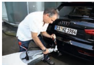
Beim Ankoppeln Sorgfalt walten lassen: Kupplung richtig einrasten, Abreißseil in Öse einhängen oder umlegen und das Bugrad sicher arretieren.
